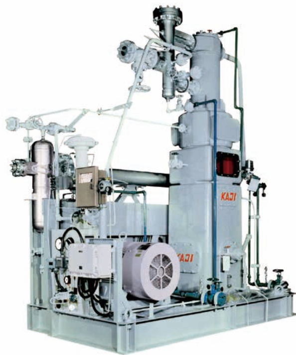
VS-75GH-OL、炭化水素、吸込 1.86MPa 吐出 5.88MPa 55kW
