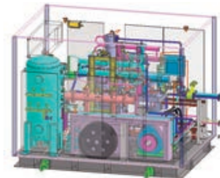
次期水素ST用圧縮機3Dモデル (防音ケースを透視 反対側から)
